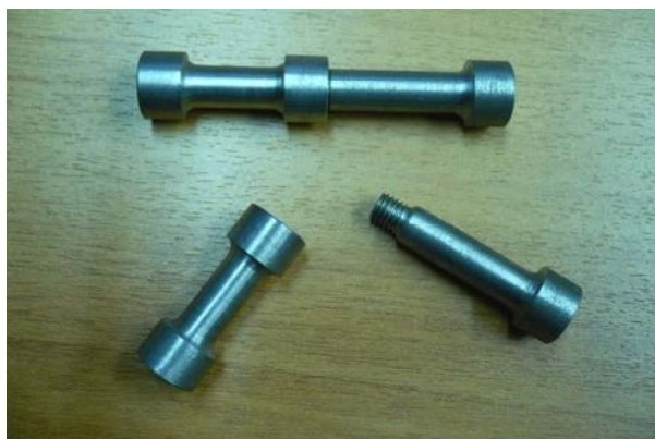
Рис. 2. Общий вид образцов резьбовых соединений при исследовании жесткости
