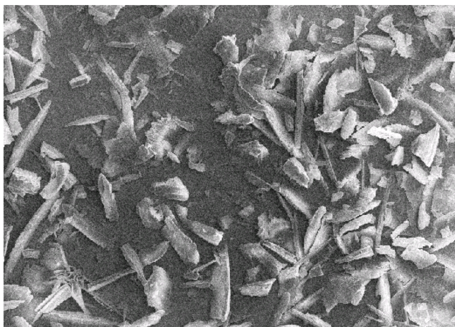
Рис. 1. Внешний вид фосфатного покрытия, полученного из состава варианта 2 (увеличение \times 130 )
