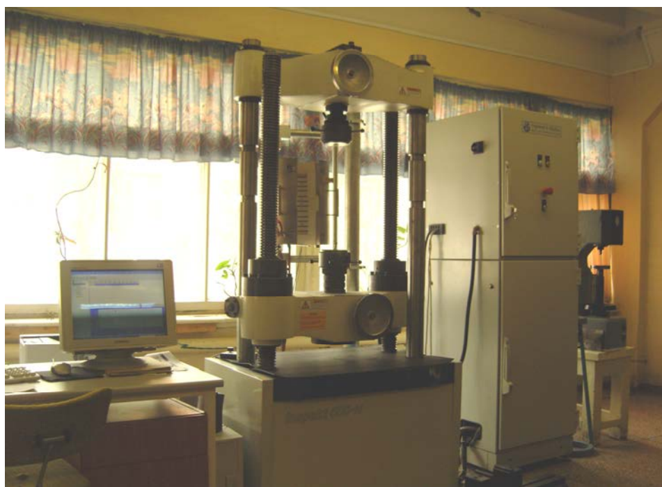
Рис. 1. Общий вид универсальной испытательной машины Inspekt 500-Н
